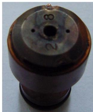
Figura 3. Bico de contato com furos laterais usado no processo plasma keyhole.
