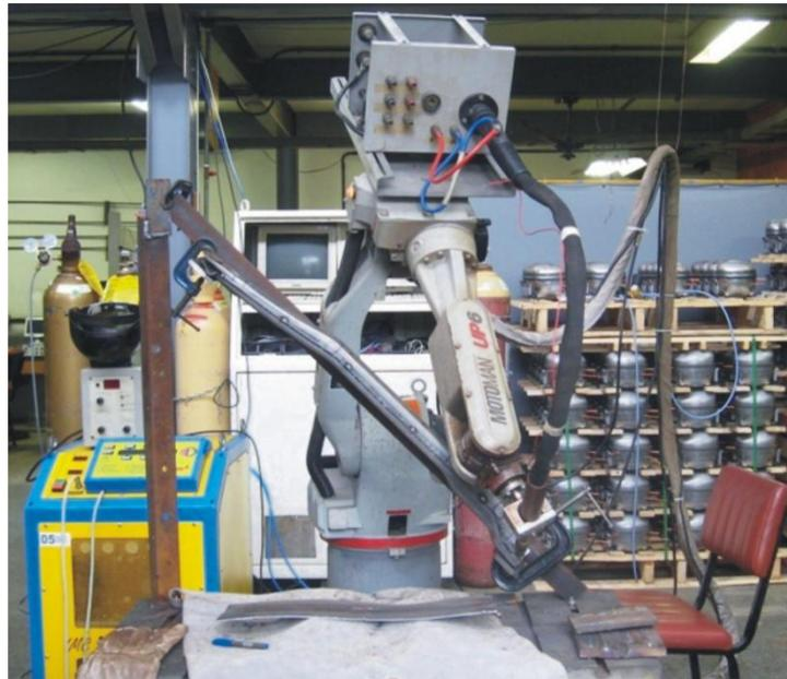
Figura 5 Bancada de ensaios da soldagem de juntas.
