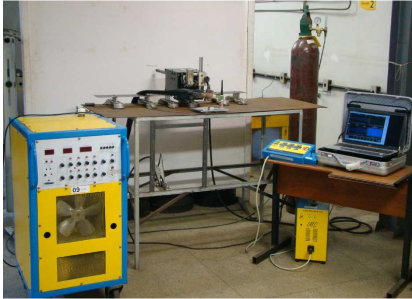
Figura 1. Bancada TIG CA para soldagem do alumínio
