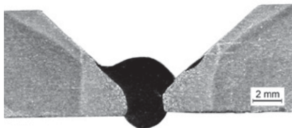
Figura 6. Formação geométrica com falta de simetria do passe de raiz na soldagem MAG com transferência por curto-circuito. Dados: V_a = 3,6 m/min; I_m = 102 A; U_m = 17 V; V_s : 3,2 mm/s; Aporte: 0,5 kJ/mm; Gás: \text{Ar}+25\%\text{CO}_2 . Chanfro de 90^\circ .
