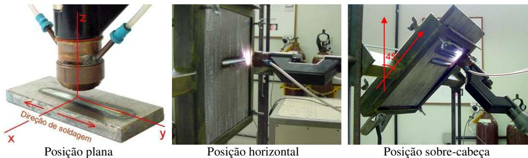
Figura 5. Fotos ilustrativas da posição da tocha para soldagem plana, horizontal e sobre-cabeça
