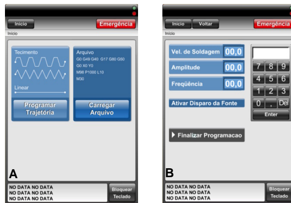
Figura 10. Telas de comando elaboradas para programação do manipulador robótico.
