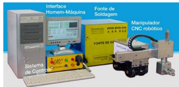
Figura 12. Componentes do sistema automático de soldagem.
