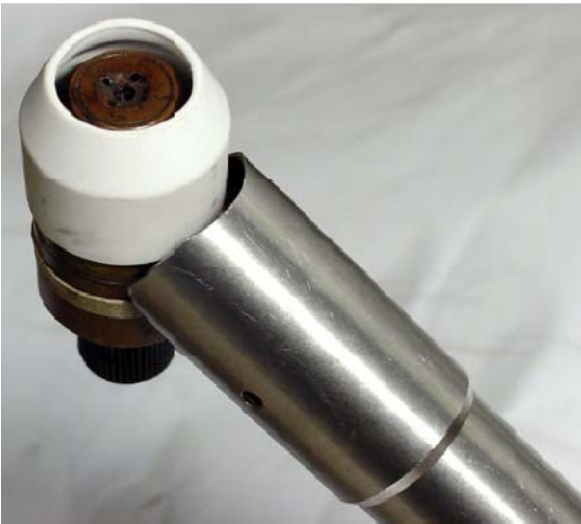
Figura 16. Tocha PTAP comercial para operação manual com 4 vias de vazão de pó.
