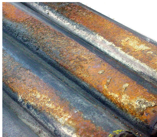
Figura 1. Região afetada por erosão e corrosão.
