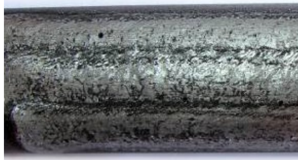
Figura 20. Tubo revestido com o processo PTAP.
