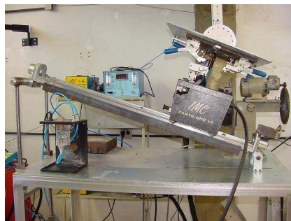
Fig. 4 – Mesa para posição plana, sistema de deslocamento automático em dois eixos, tocha de soldagem, suporte de CPs para soldas nas posições vertical, horizontal e sobre-cabeça.
