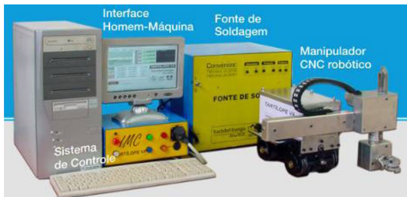
Figura 7. Componentes do sistema automático de soldagem.
