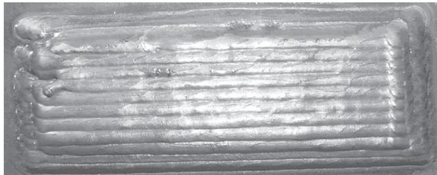
Figura 11. Duas camadas depositadas com arame E-309L na posição sobrecabeça à 45°
