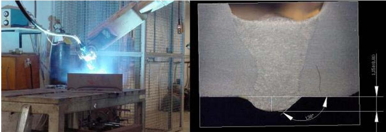
Figura 3. Processo sem respingos ou fumo. Penetração estável e regular.
