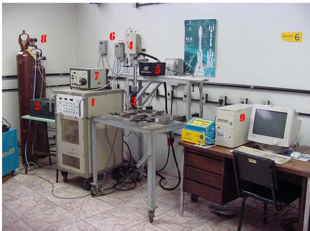
1. Fonte de soldagem 2. Módulo Plasma 3. Tocha de soldagem Plasma 4. Válvula de controle da vazão de gás de Plasma 5. Sistema de deslocamento da tocha 6. Medidores de Vazão de Gás 7. Cabeçote Alimentador de Arame 8. Gases 9. Computador
