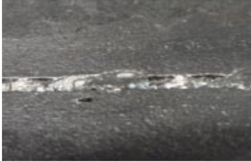
Figura 5. Aspecto do cordão com penetração insuficiente (vista inferior).
