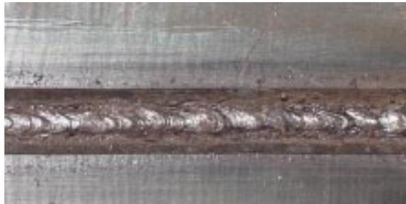
Figura 6. Aspecto do cordão (vista superior) feito pelo processo de eletrodo revestido.
