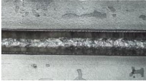
Figura 7. Aspecto do cordão (vista superior) feito pelo processo MIG curto-circuito controlado.
