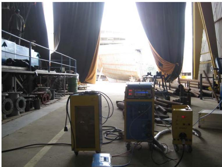
Figura 14 – Bancada – suporte para soldagem e fonte de soldagem microprocessada.
