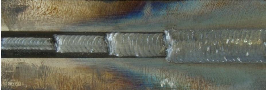
Figura 12. Cordão de solda realizado na posição sobre-cabeça com arame maciço
