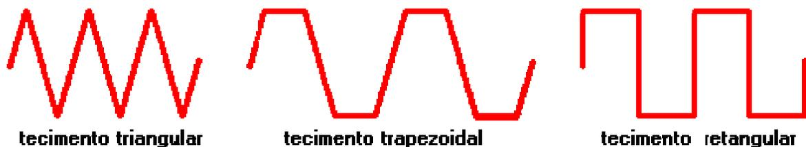
Figura 5. Tipos de tecimento do sistema robótico
