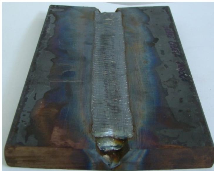
Figura 14. Cordão de solda realizado na posição sobre-cabeça com arame maciço
