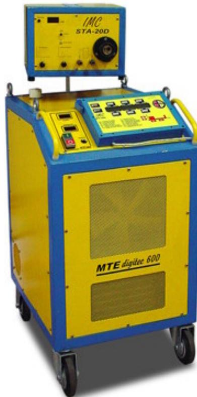
Figura 7. Fonte de soldagem MTE Digitec 600
