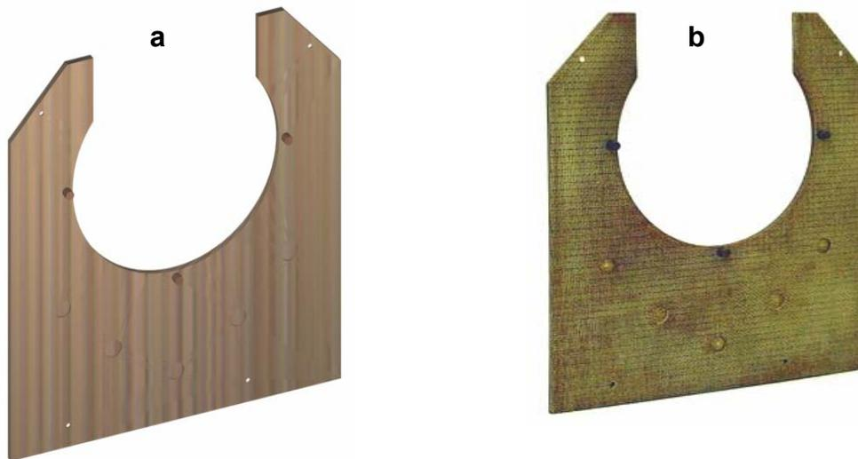
**Fig. 13** - a- Modelo da tampa de vedação (CAD); b - Tampa fabricada.
