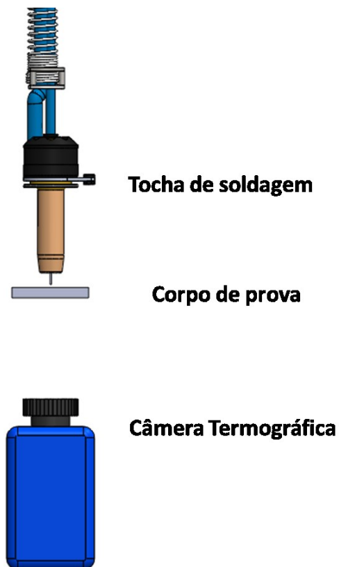
Figura 102 - Disposição da câmera termográfica em relação ao corpo de prova.
