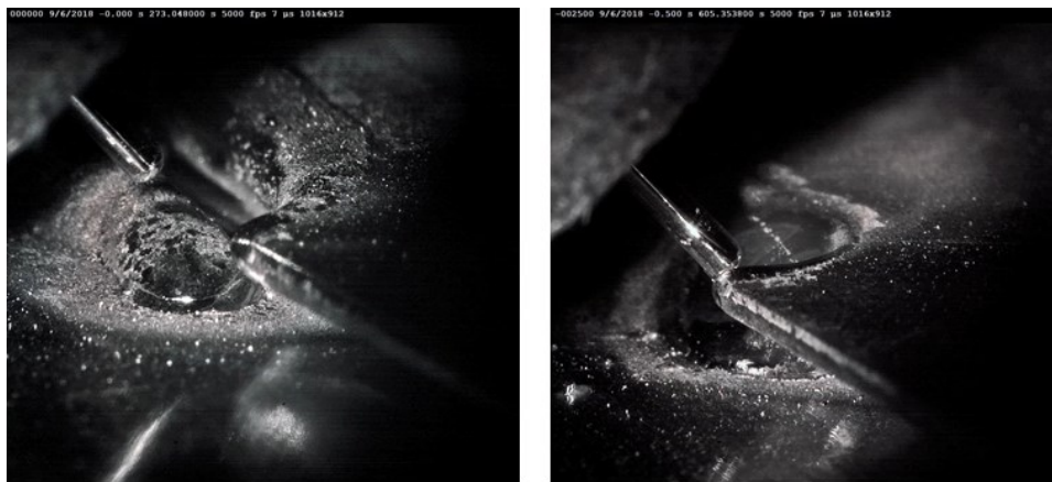
Figura 76 - Falhas no preenchimento da junta; gap = 2 mm (MIG Pulsado CC / IMC Digiplus A7).
