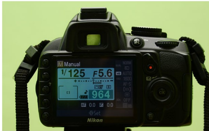
Figura 22 - Regulagem do tempo de exposição (1/125 s) em uma câmera digital portátil.
