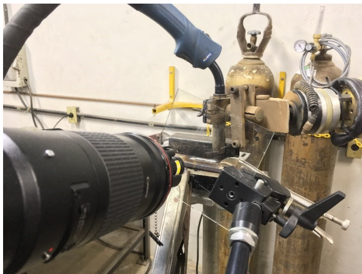
Figura 103 - Disposição da câmera de alta velocidade.
