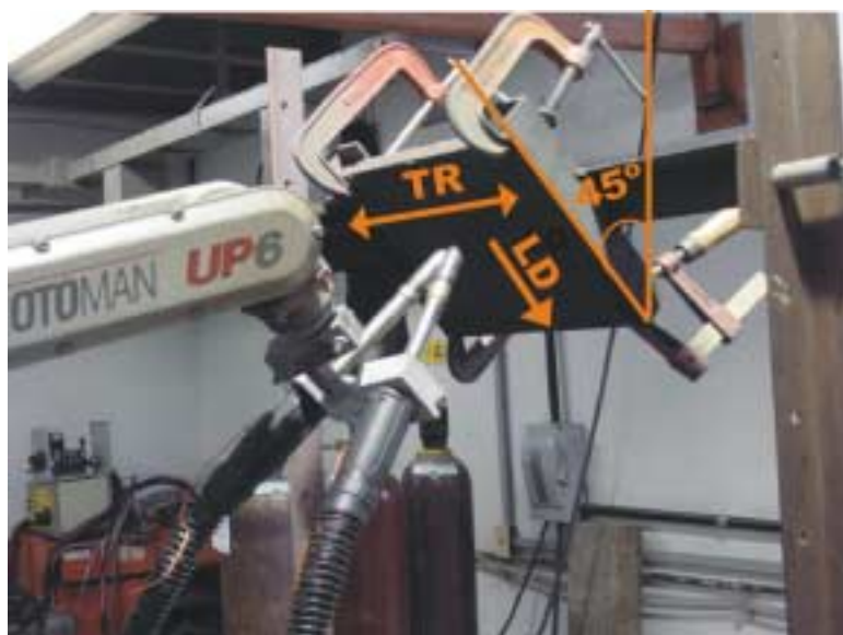
Figura 6.1 – Foto ilustrativa da posição e sentido de deslocamento das tochas.
