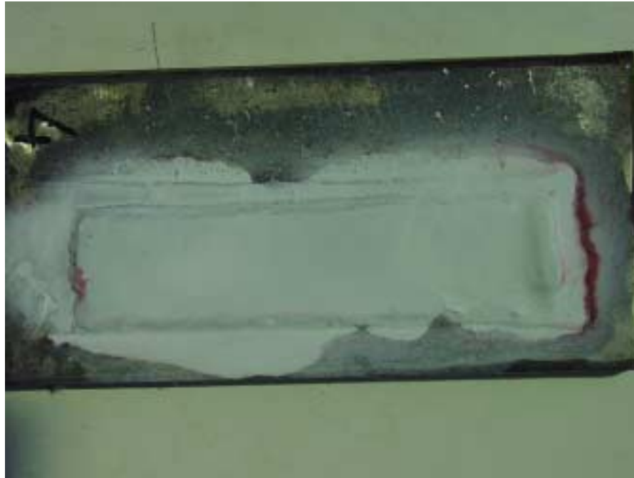
Figura 8.18 - Foto de uma das chapas submetida ao ensaio com líquido penetrante. Observa-se que não ocorreram defeitos. Condições de soldagem: ImPt = 140 A/arame; DPeB = 0%; Vs = 85 cm/min e EImp = 3,3 A.min/cm.
