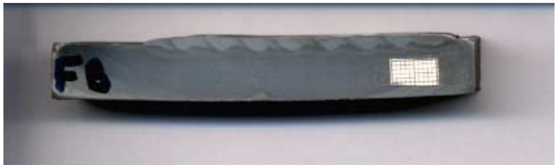
Figura 6.22 - a) e b) - Características do perfil de penetração das camadas depositadas na condição de pulsos em fase. Escala em milímetros.
