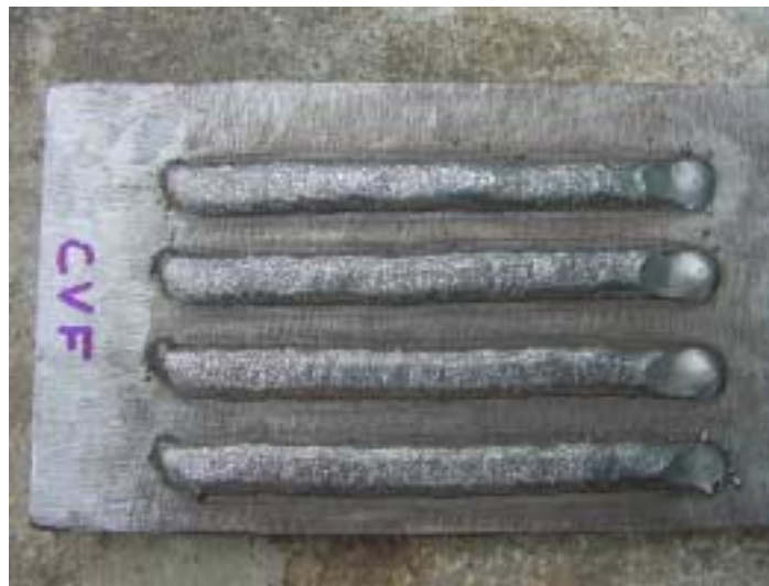
Figura 8.13 Aspectos dos cordões de solda realizados com corrente pulsada, sem a pulsação térmica e com os pulsos de destacamento ocorrendo em fase. I_m = 120 A/arame; I_p = 320 A; t_p = 5,3 ms; I_b = 32 A; t_b = 12,1 ms; V_{a\_aj1} = 6,8 m/min e V_{a\_aj2} = 6,7 m/min.
