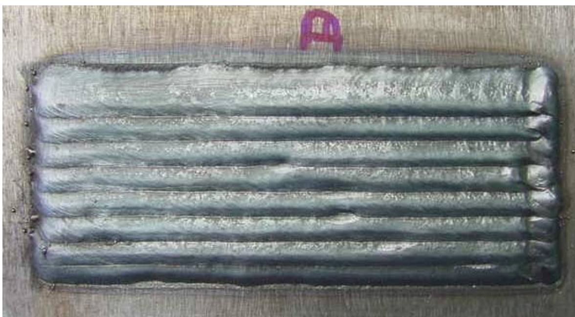
Figura 6.15 a) e b) – Fotos das camadas depositadas na condição de pulsos de corrente defasados. Corrente média de 120 A/aramé.
