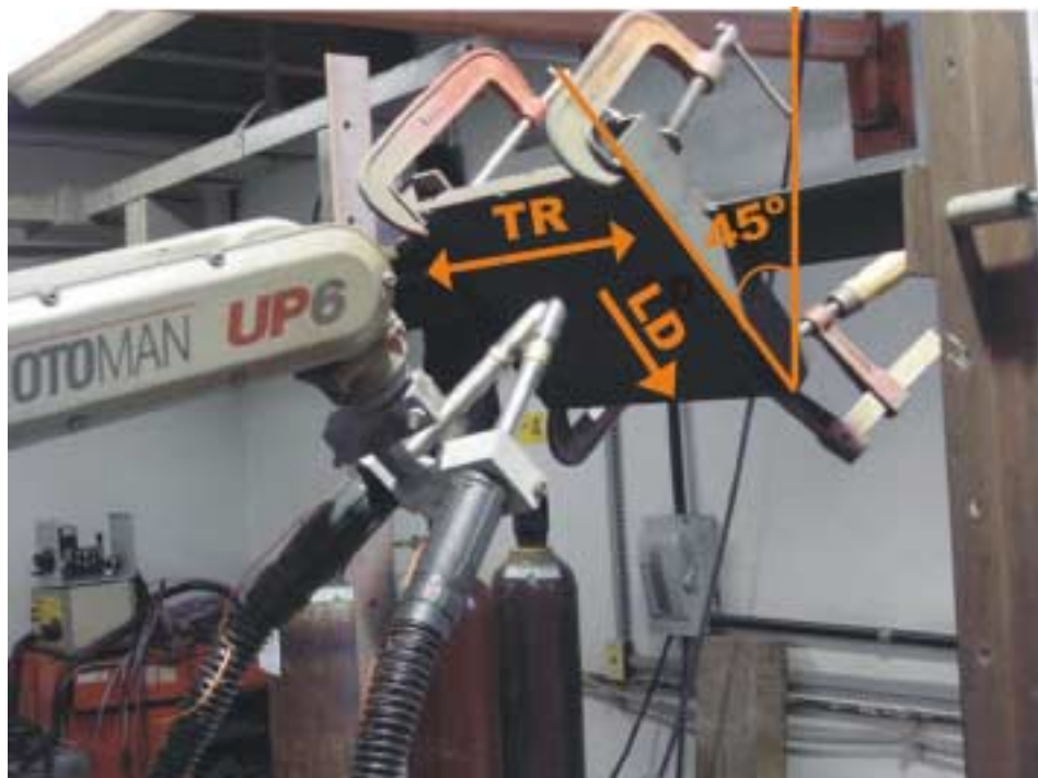
Figura 8.3 - Posição de soldagem na qual foram realizados os ensaios.
