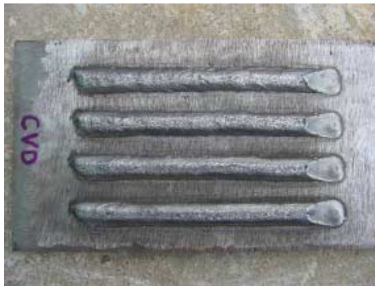
Figura 8.6 - Aspectos dos cordões de solda executados com o duplo arame. I_m = 120 A/arame; I_p = 320 A; t_p = 5,3 ms; I_b = 32 A ; t_b = 12,1 ms e diâmetro de gota calculado de 1,62 mm.
