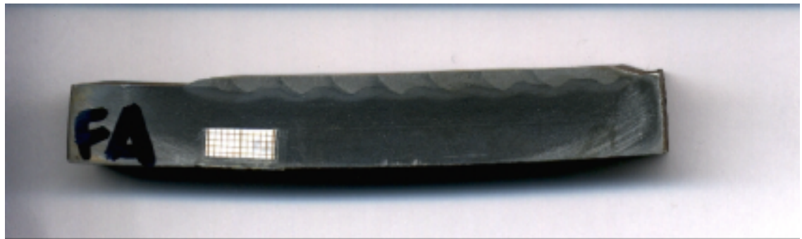
Figura 6.21 - a) e b) – Características do perfil de penetração das camadas depositadas na condição de pulsos defasados. Escala em milímetros. Cortes das seções transversais dos corpos de prova.
