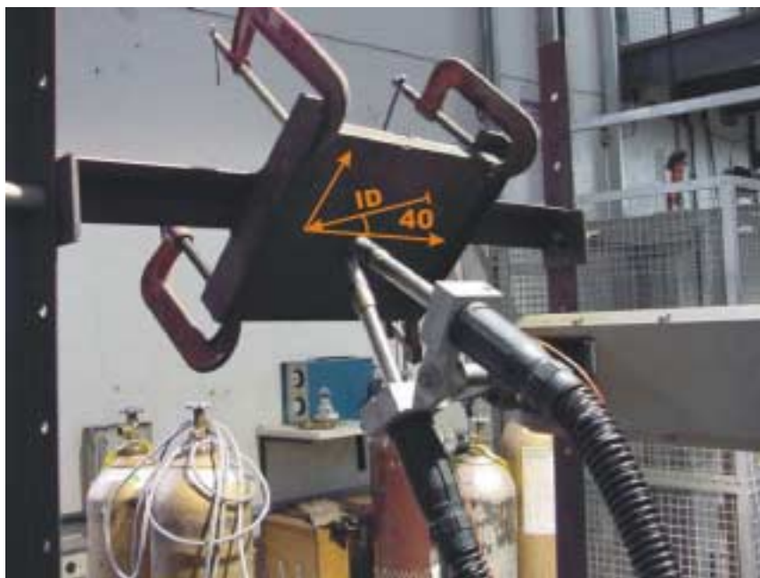
Figura 8.14 Posicionamento das tochas “lado a lado” para as soldagens na direção horizontal e em “tandem” para soldagem na longitudinal.
