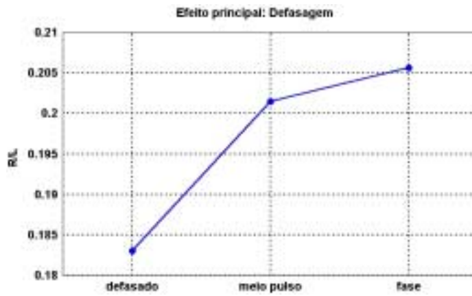
Figura 6.2 - Efeito da defasagem nos pulsos de corrente sobre o índice de convexidade dos cordões.
