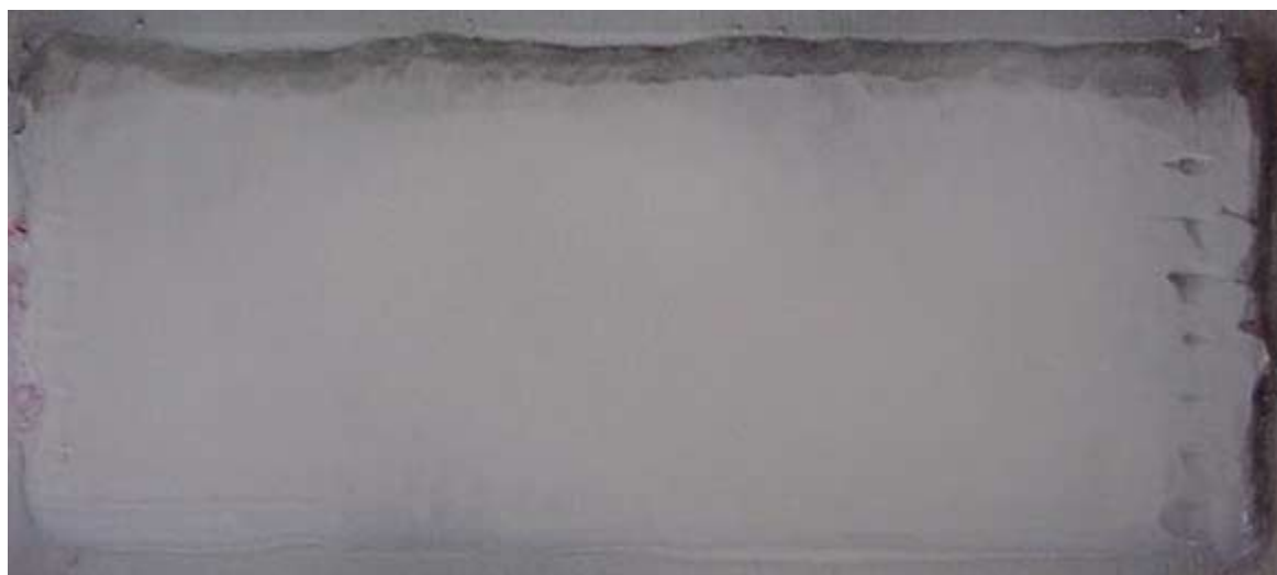
Figura 6.18 - a) e b) – Resultados do ensaio com líquido penetrante feito sobre as chapas soldadas na condição de pulsos defasados.
