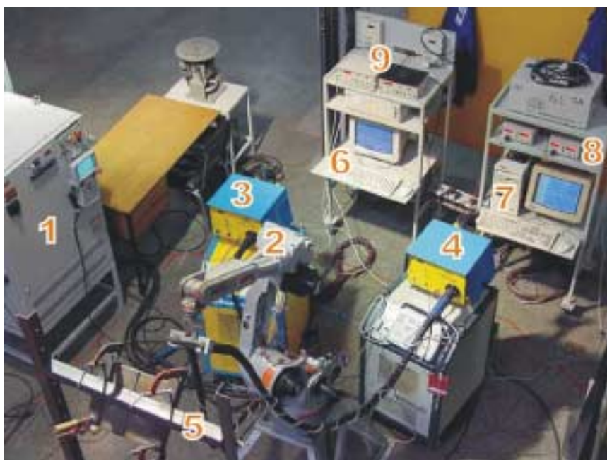
Figura 8.1- Bancada de equipamentos utilizada para realização das soldagens de revestimento.
