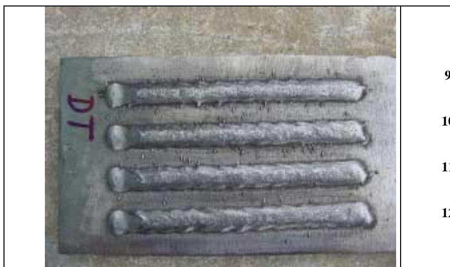
Figura 8.12- Soldas realizadas na condição de pulsos térmicos defasados
