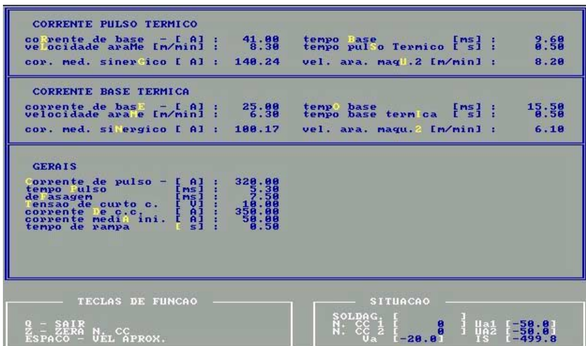
Figura 8.2 - Tela principal do programa utilizado para comandar as fontes de soldagem.
