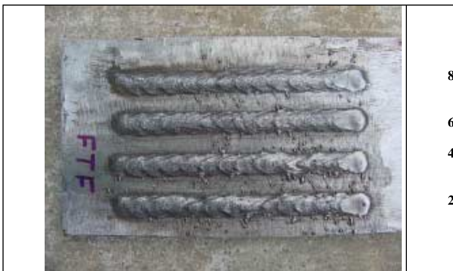
Figura 8.11- Aspectos dos cordões de solda realizados na condição de pulsos térmicos e pulsos de destacamento de gotas em fase.
