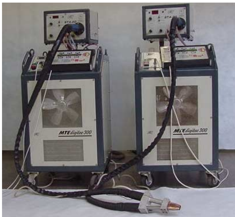
Figura 3.7 - Fotos das fontes que compõem o sistema MIG/MAG Duplo Arame Com Potenciais Isolados.
