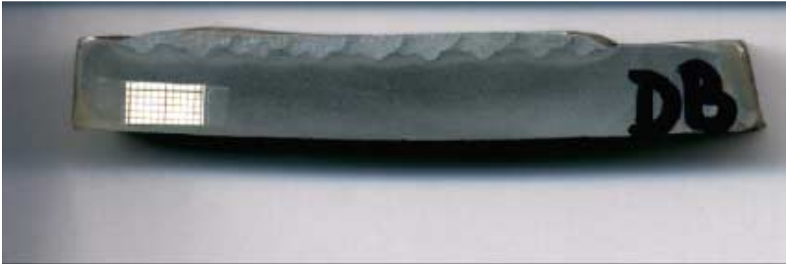
Figura 6.21 - a) e b) – Características do perfil de penetração das camadas depositadas na condição de pulsos defasados. Escala em milímetros. Cortes das seções transversais dos corpos de prova.
