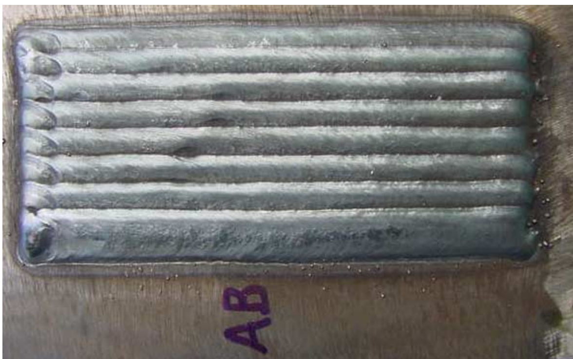
Figura 6.17 - a) e b) - Fotos das camadas depositadas na condição de pulsos aleatórios. Corrente média de 120 A/arame.
