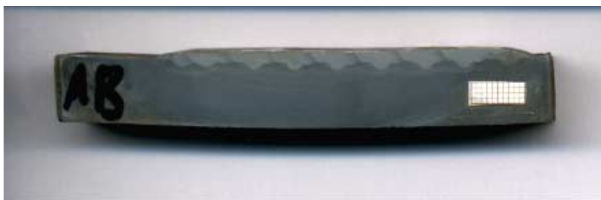
Figura 6.23 - a) e b) - Características do perfil de penetração das camadas depositadas na condição de pulsos aleatórios. Escala em milímetros.
