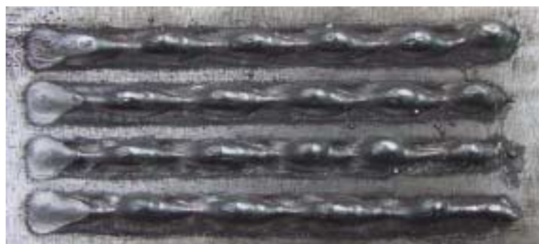
Figura 8.15– Fotos dos cordões de solda realizados segundo a direção horizontal. Os dois primeiros cordões, de cima para baixo, foram realizados com as tochas posicionadas em “tandem”, e, os outros dois, com elas posicionadas “lado a lado”.
