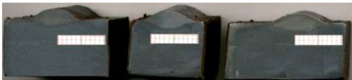
Figura 6.11 – Seções transversais de soldas realizadas com o pulsos de corrente em fase. a) 80 A; b) 120 A e c) 160 A. Escalas em mm.
