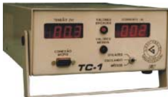
Figura 3.1 - Medidor de tensão e corrente.
