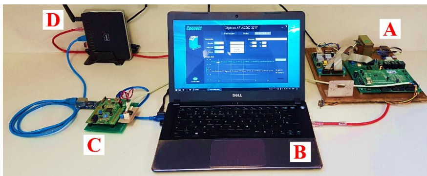
Figura 28 - Bancada de ensaio com a giga de testes (A). Computador (B) e Gateway Ethernet (C) conectados a um roteador (D).
