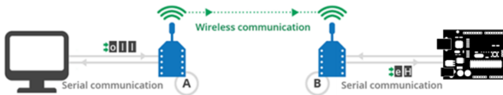
Figura 23 - Comunicação wireless substituindo comunicação serial cabeada
