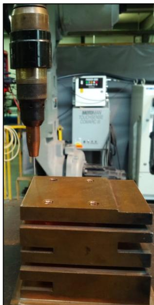
Figura 4.13 – Gabarito para Verificação dos Deslocamentos no Plano-XY.
