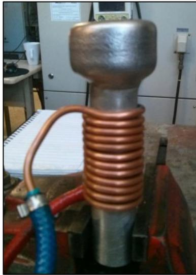
Figura 3.20 – Manufatura com o Sistema de Serpentina.
