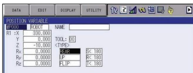
Figura 7.21– Registro de uma Variável de Posição do tipo Cartesiano.
