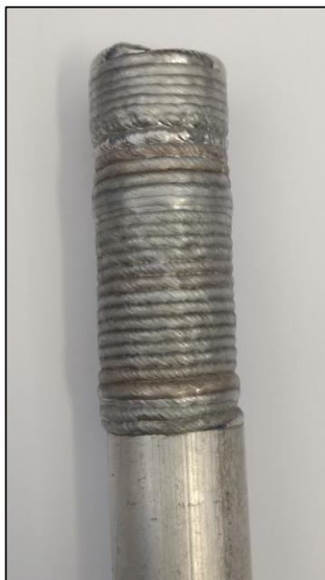
Figura 3.33 – Peça Manufaturada dentro do Tanque de Imersão.
