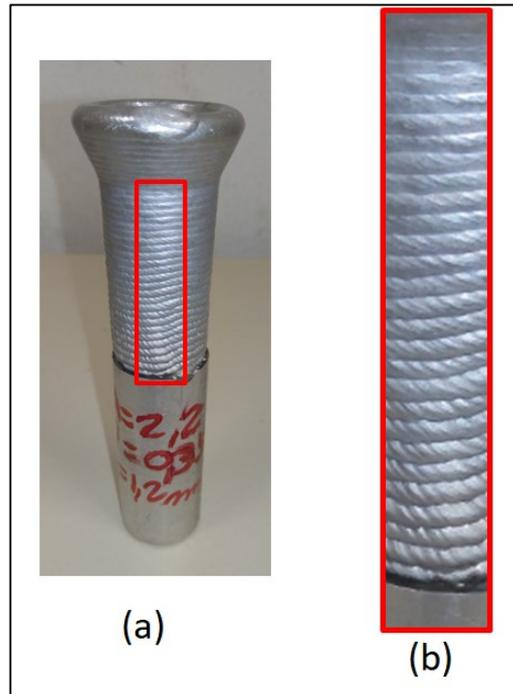
Figura 3.29 – (a) Parte Manufaturada. (b) Alteração da Geometria dos Cordões.
