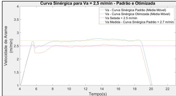
Figura 5.6 – Ensaio Sobre Chapa antes e após Otimização da Curva Sinérgica.
