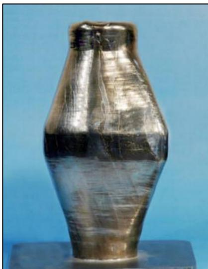
Figura 7.12 – Peça estrutural manufaturada com o processo EBF. Fonte: [67]
