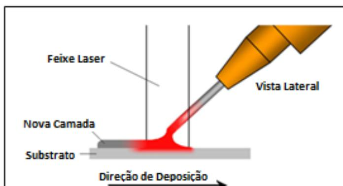
Figura 7.15 – Laser Metal Deposition-wire. Fonte: [68]
