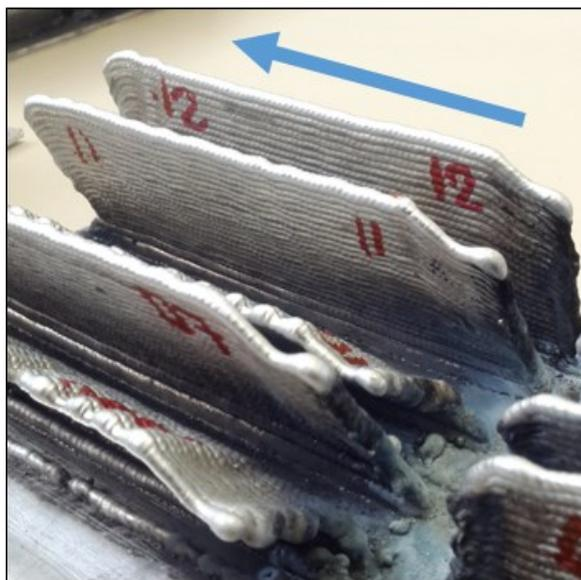
Figura 5.20 – Deformação no Início das Paredes.
