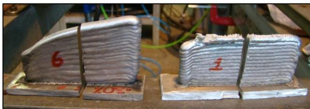
Figura 2.16 – Influência do Tempo de Resfriamento entre Deposições.
