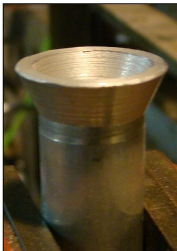
Figura 3.27 – Peça após Processo de Usinagem.
