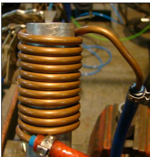
Figura 3.19 – Serpentina em torno do Tubo Base.
