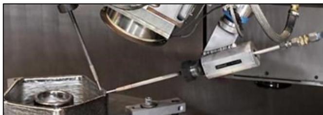
Figura 7.14 – Processo EBAM com configuração de duplo arame. Fonte: Sciaky Inc.
