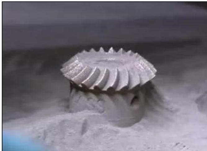
Figura 7.3 – Peça manufaturada utilizando o processo DMLS. Fonte: YouTube
