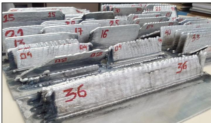
Figura 5.19 – Paredes Manufaturadas Utilizadas como Corpos de Prova.
