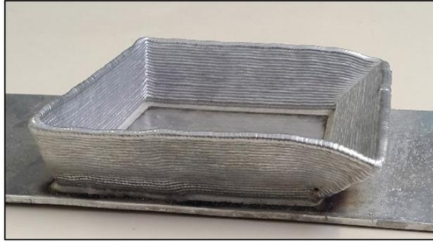
Figura 5.34 – Primeiro Sólido Manufaturado com Seleção Automatizada de Parâmetros.
