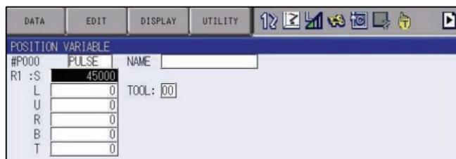
Figura 7.20 – Registro de uma Variável de Posição em modo Pulso.
