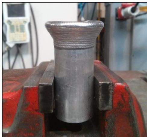
Figura 3.26 – Peça Manufaturada com o Segundo Dispositivo de Refrigeração.
