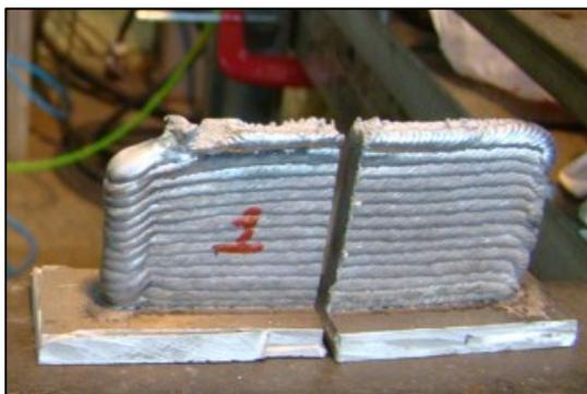
Figura 2.14 – Colisão devido a Erro na Estimativa da Altura de Camada.
