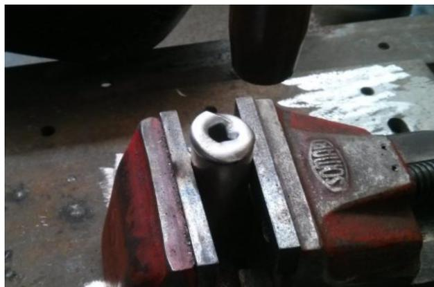
Figura 3.18 – Tubo Base Fundido.
