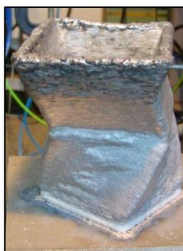
Figura 2.15 – Efeito da perda da proteção gasosa devido ao aumento excessivo da DBCP.
