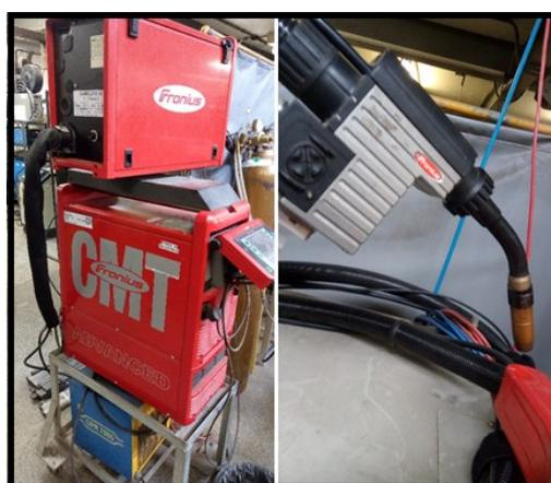
Figura 4.1 – Fonte de Soldagem *CMT Advanced - Fronius*.
