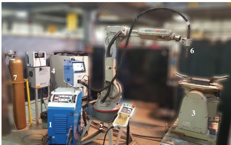
Figura 50 – Bancada experimental adotada para os ensaios de soldagem preliminares, onde: 1 – Fonte de soldagem IMC Digiplus A7; 2 – Robô antropomórfico de 6 eixos MOTOMAN HP20D; 3 – Mesa Rotativa MOTOPOS com 2 eixos; 4 – Unidade de controle do manipulado Modelo DX100; 5 – Pendant NX 100; 6 – Tocha MIG Semiautomática TBI; 7 – Cilindro de gás de proteção com mistura de 75% Argônio e 25% de dióxido de carbono (C25).
