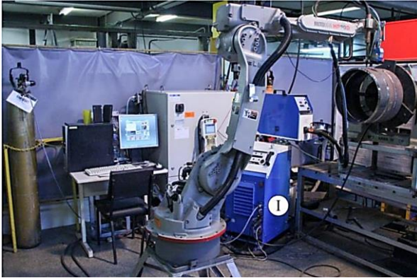
Figura 32 – Configuração utilizada por Kindermann [6] para os ensaios de soldagem adaptativa.
