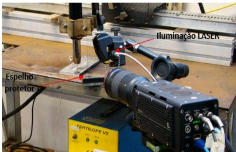
Figura 3.11. Configuração utilizada para monitoração com filmagem em alta velocidade.
