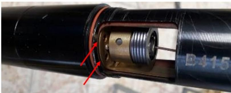
Figura 5.24. Detalhe da tocha *Spinarc* com ênfase nos orifícios de saída do gás de proteção (total de 8 saídas).
