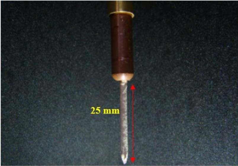
Figura 3.9. “Teach tip”: Bico de contato com arame de 25 mm fixado a sua ponta utilizado para a aferição do diâmetro efetivo de giro.
