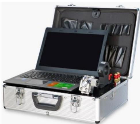
Figura 3.7. Sistema de aquisição de dados portátil do fabricante IMC Soldagem.
