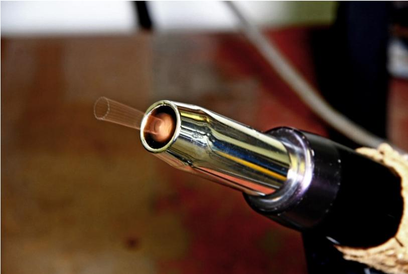
Figura 1.2. Ilustração da tocha *Spinarc* sendo rotacionada em alta frequência.  $W = 3000$  rpm. Fonte: O autor
