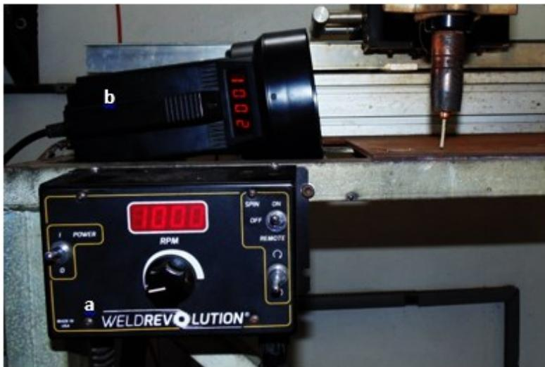
Figura 3.8. Configuração utilizada para a monitoração da velocidade de rotação: (a) Caixa controle, (b) Lâmpada Estroboscópica.
