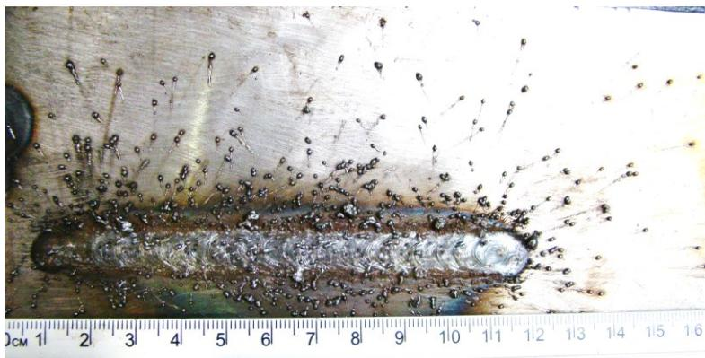
Figura 4.6. Demonstração da inviabilidade ao se realizar um depósito sobre chapa com frequência de rotação igual ou superior a 3000 rpm;  $P_c = 3$ .
