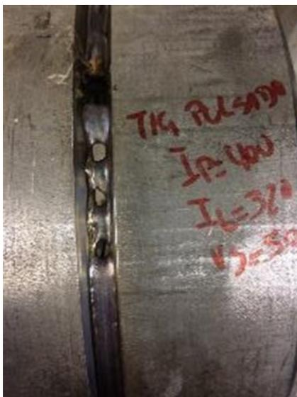
Especialmente por este motivo, decidiu-se modificar a metodologia de alta produtividade, com elevadas correntes e velocidades de soldagem. Portanto, as soldas apresentadas na Figura 5.43 foram realizadas no modo operacional *melt-in*, conforme citado no item 5.3.1. Assim, empregou-se uma parametrização sobre a qual não se utilizava elevada velocidade de soldagem e velocidade de alimentação de arame, comparadas às utilizadas com o equipamento comercial. Além disso, em
