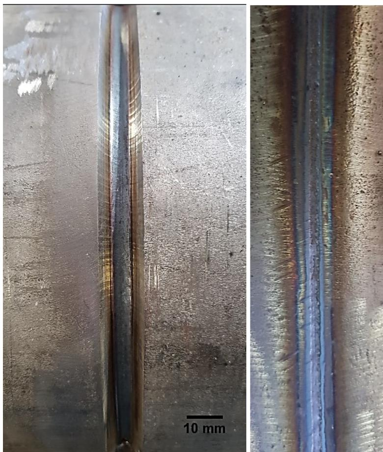
Em relação à face interna, o procedimento conferiu penetração total. Contudo, na região da posição sobre cabeça o perfil de penetração apresentou uma leve concavidade no material fundido que pode ser verificada com auxílio das macrografias apresentadas na Figura 5.25.
