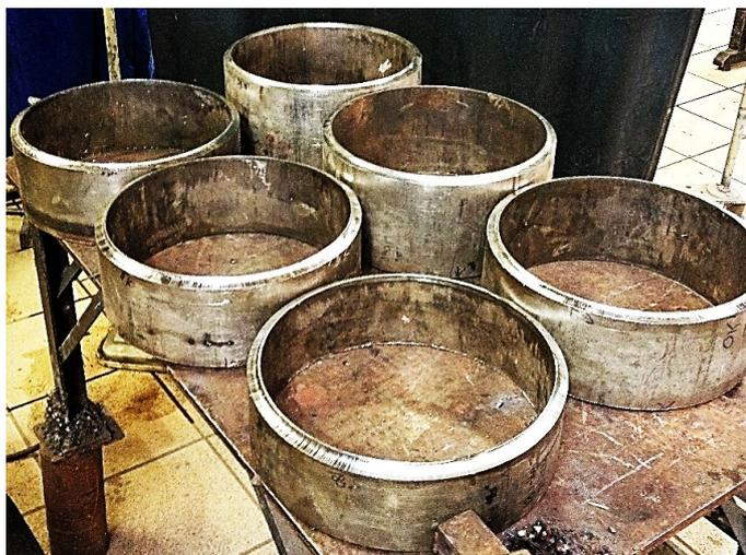
Após a montagem da junta, o corpo de prova era inserido no posicionador MOTOPOS e fixado. Devido a não padronização dimensional da fabricação dos anéis, acarretando em uma variação da posição da junta no espaço, a trajetória da tocha no robô era programada manualmente a cada conjunto de anéis montados na bancada.
