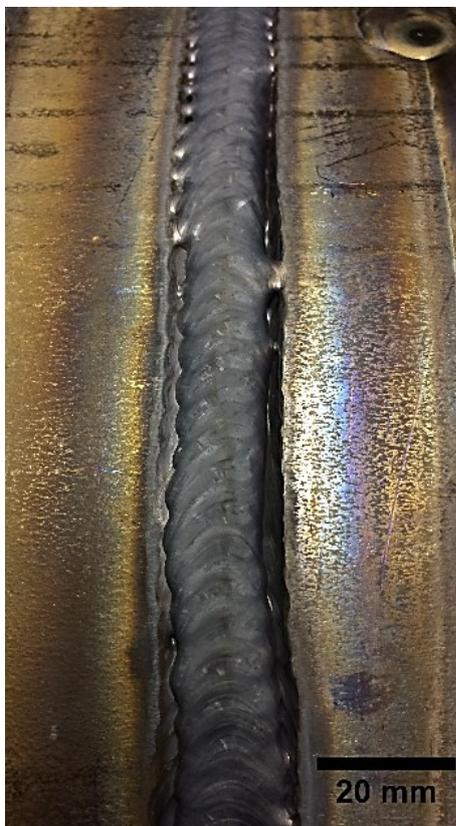
Além de comprometer a vida útil do eletrodo em relação à contaminação e provocar súbito aumento do comprimento do arco, pois o arame não era totalmente fundido pelo arco sendo inserido a uma velocidade relativamente alta o que, por consequência, afastava a tocha da peça. Deste modo, o cordão apresenta convexidade exagerada no meio e não oferece fusão nas bordas do chanfro, devido a solidificação acelerada da poça de fusão com o aumento de material de adição.
