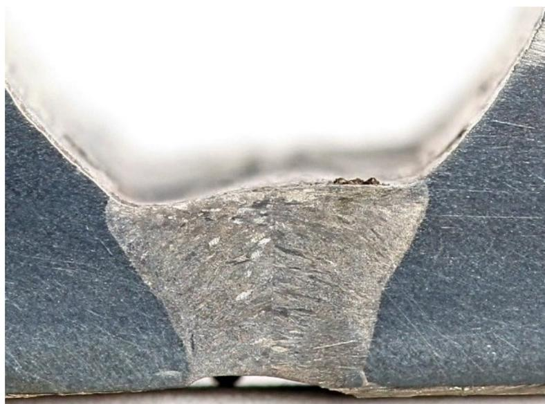
No presente estudo, a transferência metálica na soldagem do passe de raiz e de preenchimento ocorreu no modo não interrompido (ponte). A alimentação de arame aconteceu por trás do arco, o que contribuiu para não contaminação do eletrodo
