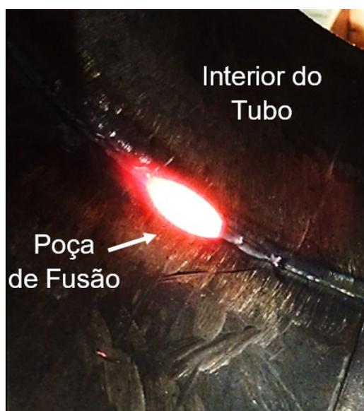
Durante a soldagem do passe de raiz nos tubos de aço inoxidável, o maior desafio era contornar os efeitos da variação da poça de fusão dentro do chanfro, principalmente em virtude da variação da posição de soldagem ao longo da junta e sobretudo das forças atuantes no processo. Tais variações impactaram diretamente
