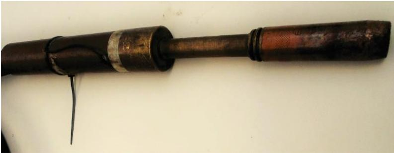
Figura 38 – Tocha de soldagem MIG/MAG fabricante TBI Industries.
