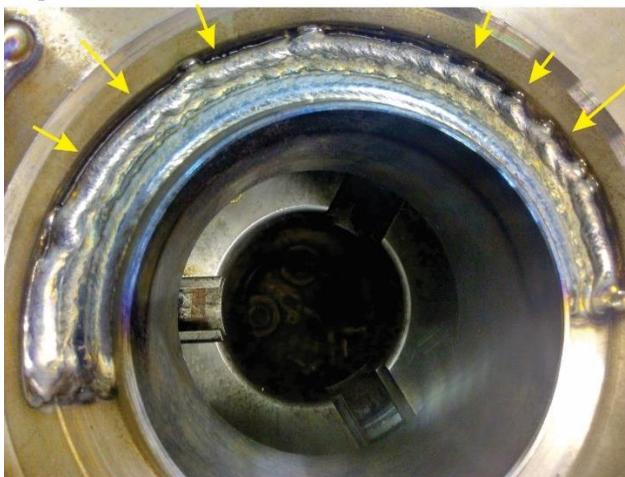
Figura 48 – Resultado da execução do procedimento na etapa 1. Em destaque (setas amarelas) a dificuldade encontrada para a fusão do material junto aos bordos do chanfro.
