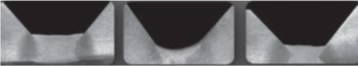
**Figura 3 – Comparação de passes de raiz entre curto-circuito com controle de corrente (esquerda), TIG (centro) e MIG/MAG convencional (direita) [35]**
