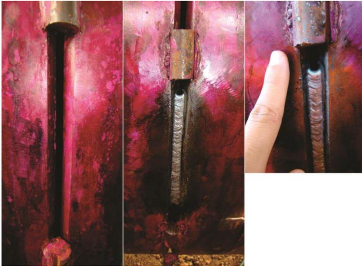
**Figura 2 – Abertura de raiz em solda realizada com TIG manual**
