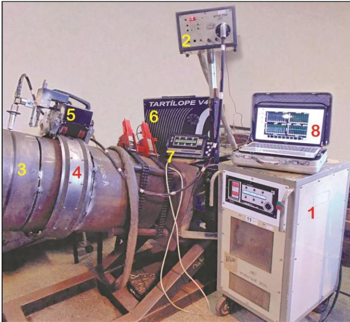
**Figura 24 - Bancada de Ensaio: 1 - Fonte de energia; 2 - Cabeçote alimentador de arame; 3 - Tubo; 4 - Trilho do manipulador; 5 - Manipulador da tocha; 6 - Unidade de controle do manipulador; 7 - IHM; 8 - SAP**
