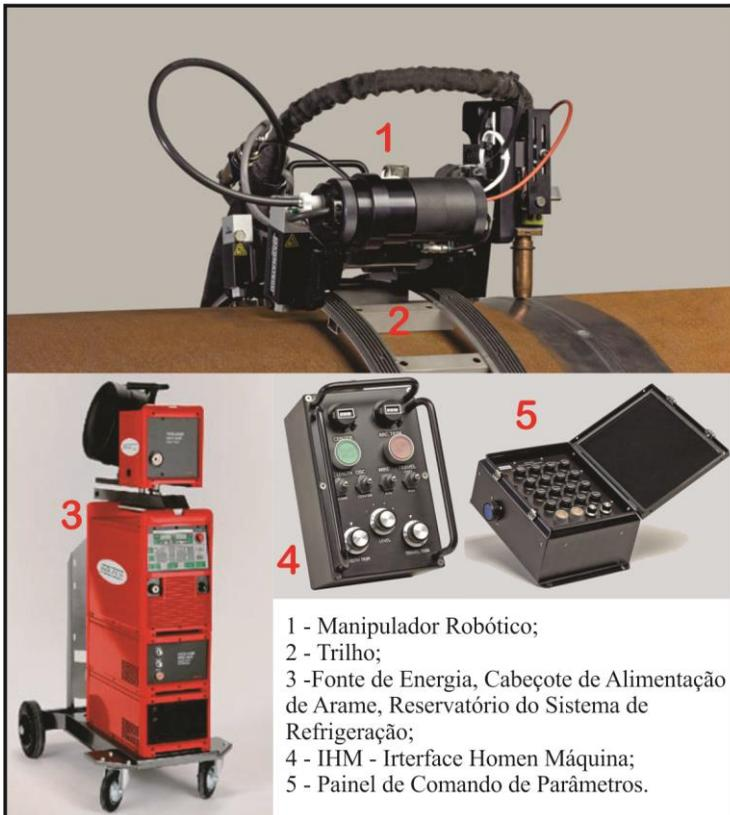
**Figura 15 - Sistema de soldagem orbital Magnatech – adaptado de [52]**
