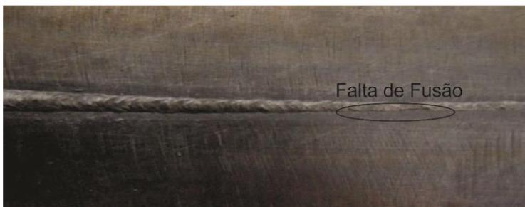
**Figura 12 - Falta de fusão e variação de gap em cordão de raiz**
