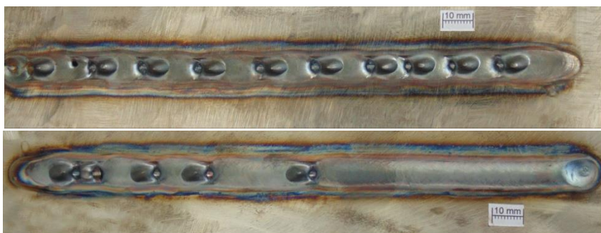
Figura 36 - cordões soldados com deslocamento linear.
