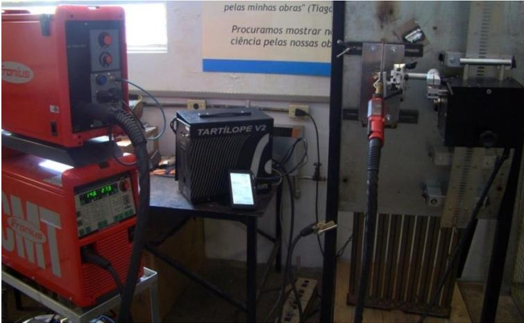
Figura 10 - Bancada de ensaios CMT
