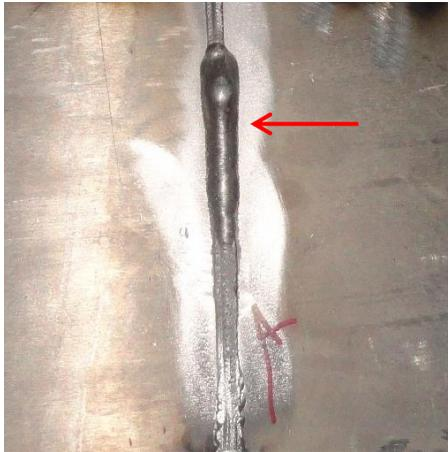
Figura 45 - Defeito observado na raiz durante a execução de preenchimento com MIG Pulsado com corrente contínua
