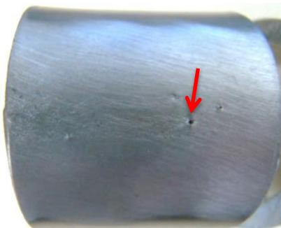
Figura 24 – Detalhe abertura de poros no ensaio de dobramento com liga 5183
