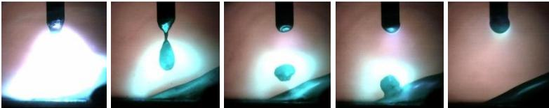
Figura 49 - Sequência destacamento de uma gota por pulso oscilograma Figura 49 (a)
