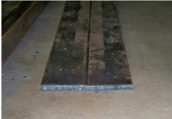
Figura 14. Solda de topo em chapa de 3/4" de espessura em *marine steel* DH-36 [18]
