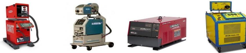
Figura 4. Fontes *Fronius CMT* [30], *OTC DW 300* [31], *Lincoln Power Wave* [32] e *IMC Digitec 600* [33], da esquerda para direita
