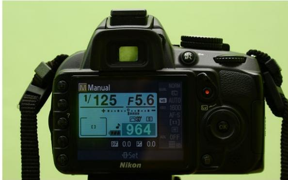
**Figura 6 - Regulagem do tempo de exposição (1/125 s) em uma câmera digital portátil. Fonte: Wikihow (2017).**
