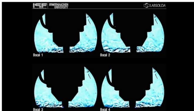
**Figura 24 - Imagens obtidas com a técnica Schlieren comparando o fluxo de gás com os diferentes bocais <sup>10</sup>. Obtidas com o arco aberto e gás argônio. Vazão utilizada: 10 l/min. Fonte: Schwedersky (2015).**
