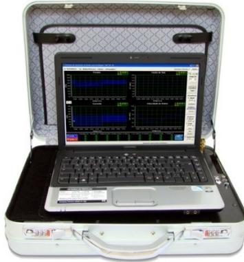
**Figura 8 - Sistema de Aquisição Portátil (SAP). Fonte: LABSOLDA-UFSC (2017).**
