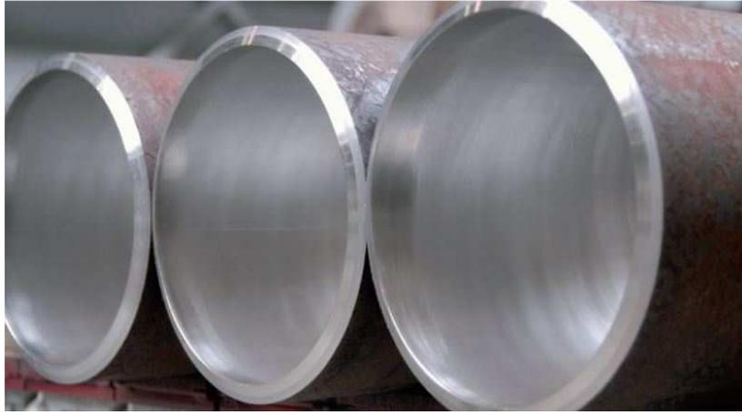
Figura 1. Tubo de aço carbono cladeado metalurgicamente [2].
