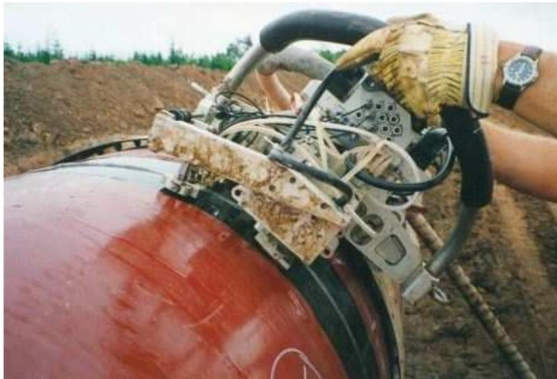
Figura 14. Equipamento AUT para inspeção em campo [27].
