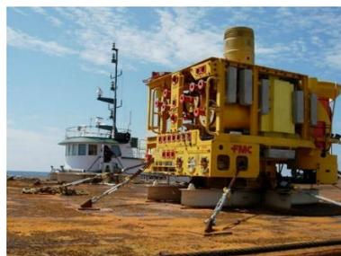
Figura 1 - Estrutura de árvore de natal para aplicações submarinas de extração de petróleo. Fonte: [1]
