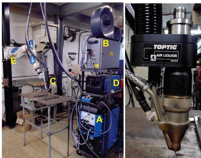
Figura 5 - Bancada de ensaios à esquerda (A – Fonte de soldagem; B - Sistema de alimentação de arame; C - Tocha; D – Sistema de refrigeração; E –Robô antropomórfico) e a direita em destaque a tocha *TOPTIG*
