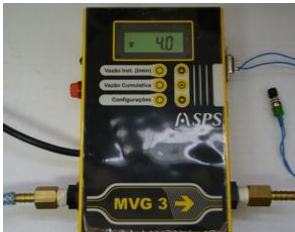
Figura 6 - Tela do monitoramento da vazão mínima.
