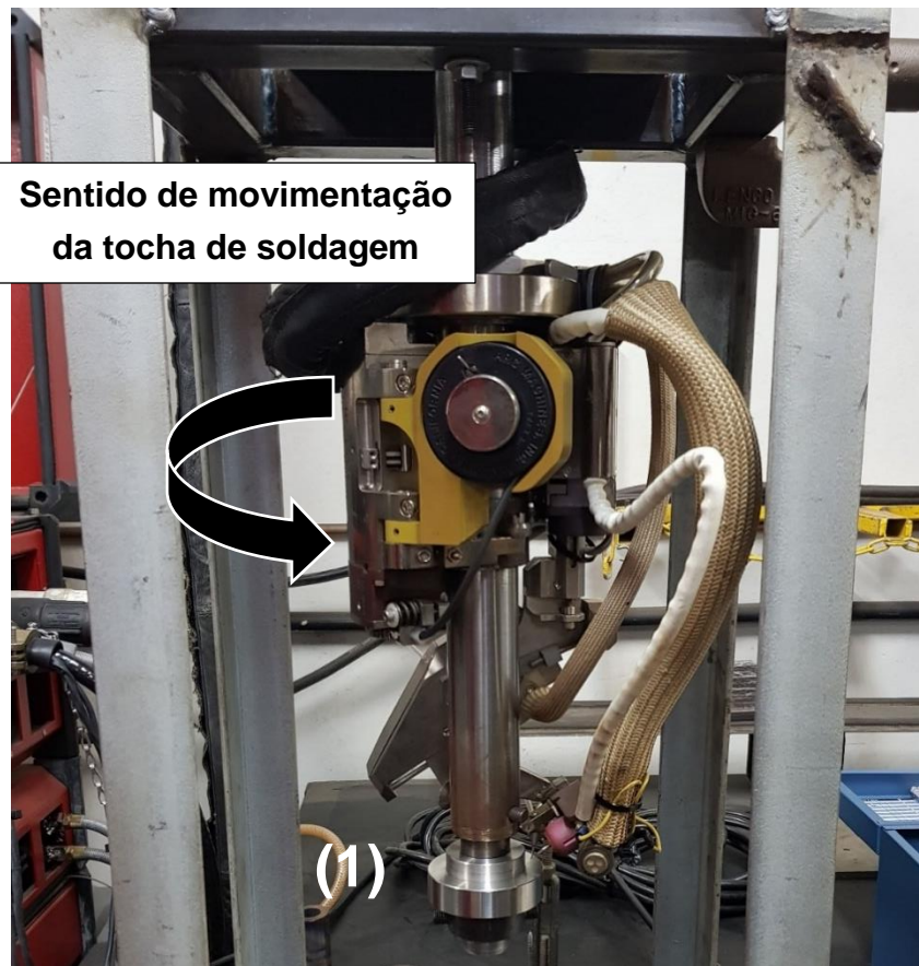
Figura 23 - Cabeçote de soldagem - (1) - Corpo de prova
