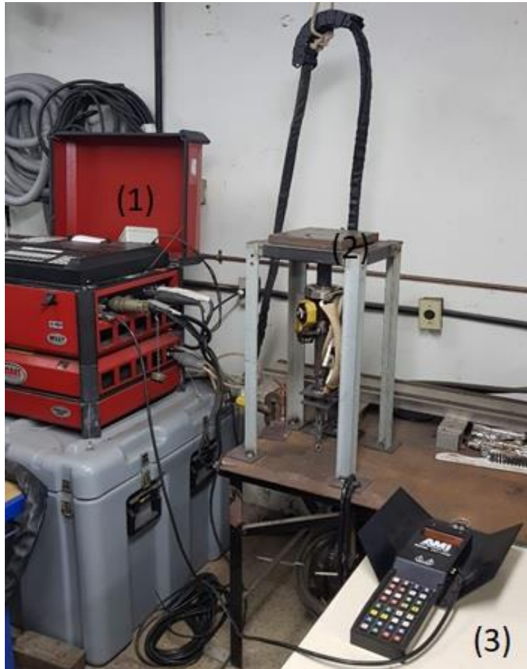
Figura 22 - Bancada de ensaios: (1) – Fonte de soldagem; (2) – Cabeçote de soldagem e estrutura de sustentação; (3) – Controle remoto integrado.
