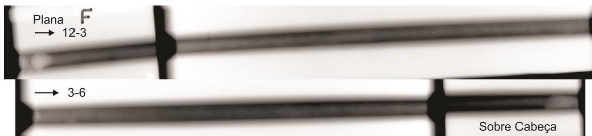
Figura 61 - Radiografia do cordão de solda com o processo STT com CO<sub>2</sub>
