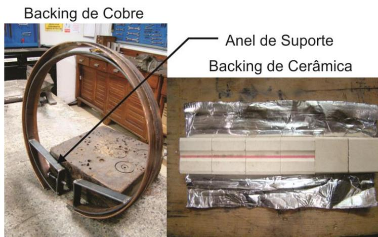
Figura 36 - *Backing* de cobre e de cerâmica
