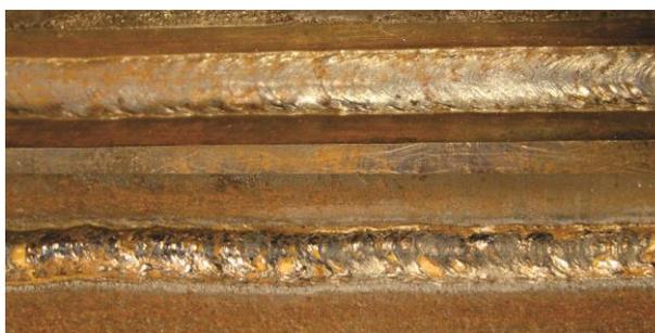
Figura 51 - Cordão de solda do processo STT com arame de 1,2 mm
