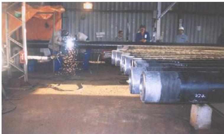
Figura 5 - Soldagem do passe de raiz e quente e *rack* de alimentação no primeiro plano
