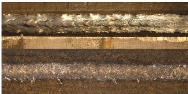
Figura 41 - Cordão de solda MIG/MAG Convencional com arame de 1,2 mm
