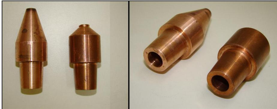
Figura 32 - Eletrodos usinados em liga de CuCrZr.
