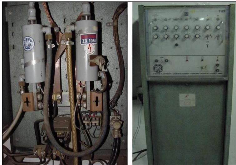
**Figura 18 - Antigo controle eletrônico (Ignitrons).**
