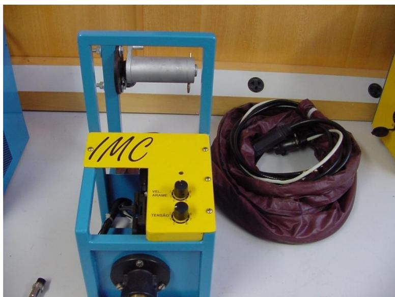
**Figura 43 - Cabeçote alimentador de arame da fonte de soldagem Larry**
