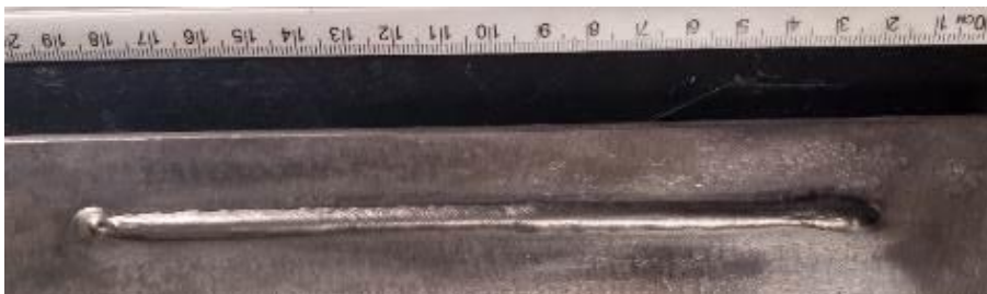
Figura 9 - Teste Hot Wire. Va = 2,2 m/min e lw = 150 A.
