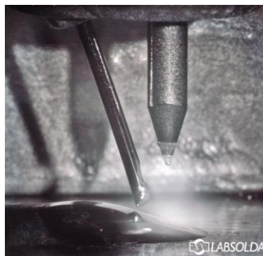
Figura 43 - Transferência metálica intermitente. Fonte: LABSOLDA.
