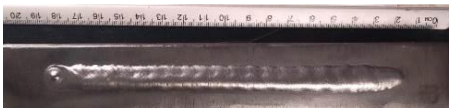
Figura 5 - Teste com ColdWire, Vs = 15cm/min e Va = 1,7m/min
