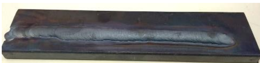
Figura 5 - Teste Cold Wire. Sentido de soldagem da esquerda para direita. Partindo de uma velocidade de alimentação inicial de 1m/mim, e finalizando em 1,7 m/min.
