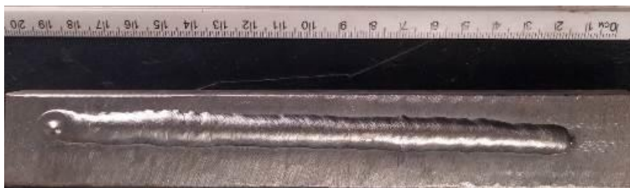
Figura 9- Teste com HotWire - 150A. V_s = 15\text{cm/min} e V_a = 1,7\text{m/min}
