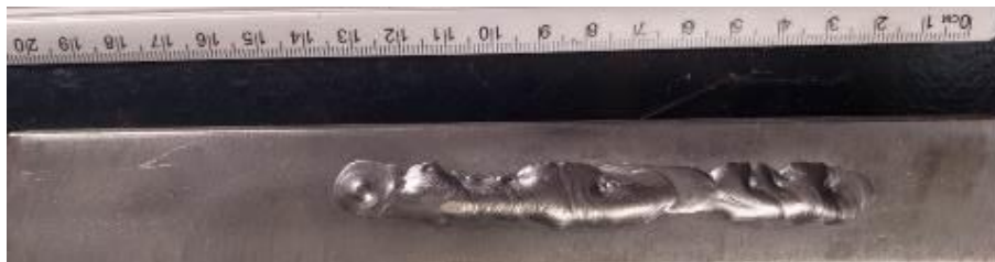
Figura 11 - Teste Cold Wire. V_a = 2,2 m/min.
