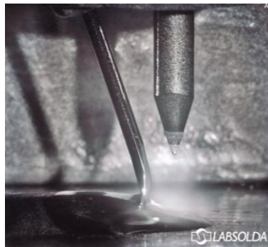
Figura 3 - Transferência metálica por ponte. Fonte: LABSOLDA.
