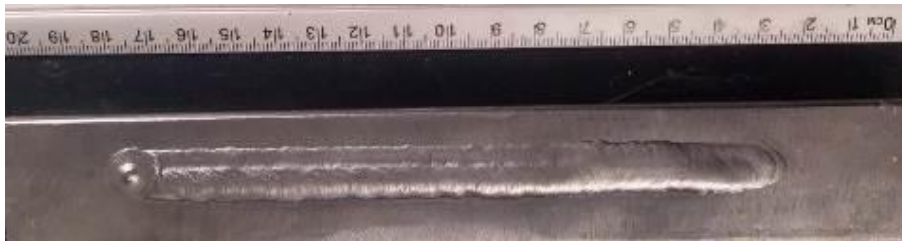
Figura 10 - Teste Cold Wire. V_a = 1,5 m/min.
