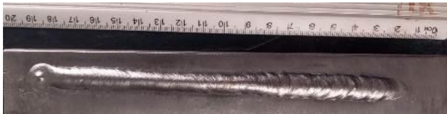
Figura 7 - Teste com HotWire - 75A. V_s = 15\text{cm/min} e V_a = 1,7\text{m/min}
