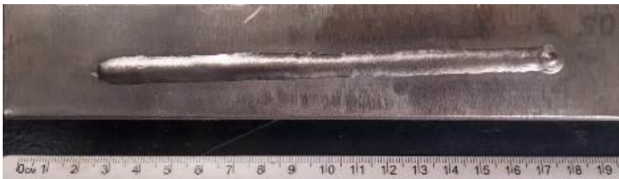
Figura 8 - Teste Hot Wire. Va de transição= 1,5 m/min e lw = 75 A.
