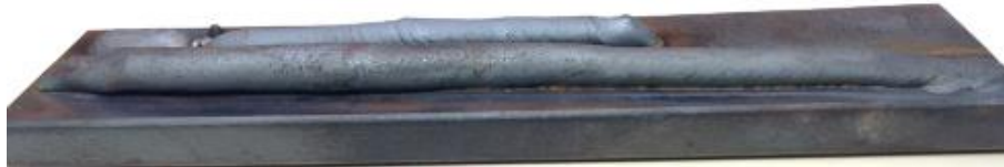
Figura 6 - Teste HotWire. Sentido de soldagem da direita para esquerda. Com uma velocidade de alimentação inicial de 1,7 m/min com aumento gradativo até finalização em 3,6 m/min.
