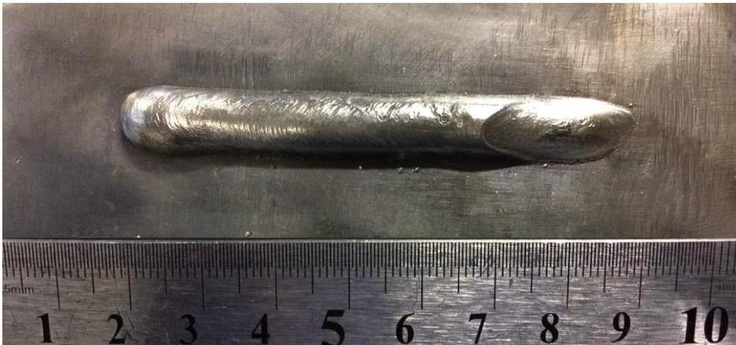
Figura 7. Aspecto visual do cordão de solda com os parâmetros definidos a partir do expoente 1,79 [Ip: 370A, tp: 2,4ms, Ib: 100A, tb: 10,4ms]
