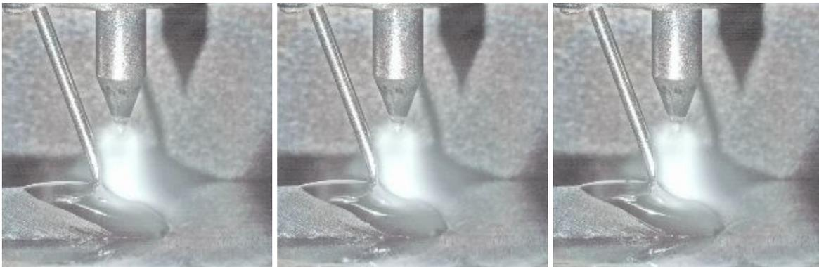
Figura 2 - Representação da transferência metálica por ponte obtida via filmagem de alta velocidade.
