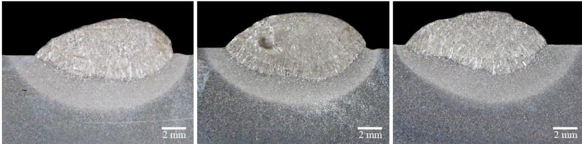
Figura 12 – Macrografias dos cordões de solda obtidos com a utilização do bocal TIG-AT. a) 15° b) 20° e c) 25°
