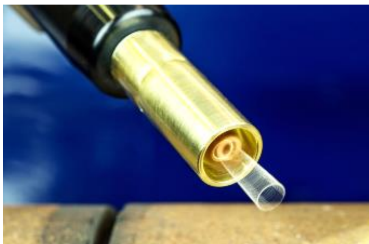
Figura 1 – Tocha Spinarc em alta frequência de rotação.
