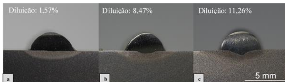
Figura 9. Seção transversal dos depósitos efetuados na posição plana e respectivas diluições. a) MIG/MAG AD; b) MIG/MAG AD-P (50%); c): MIG/MAG Pulsado.
