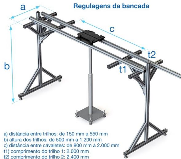
Figura 3. Modelo em CAD 3D da bancada desenvolvida em perfis de alumínio apresentando as principais regulagens disponíveis
