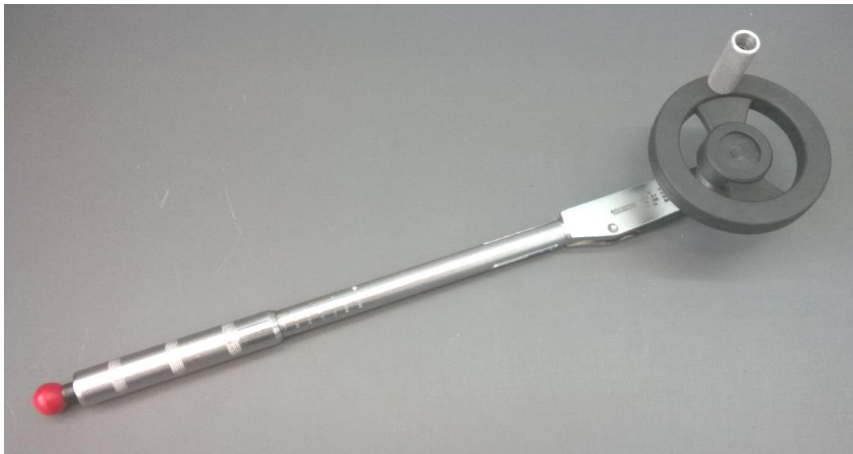
Figura 2 - Torquímetro e volante utilizados no teste.
