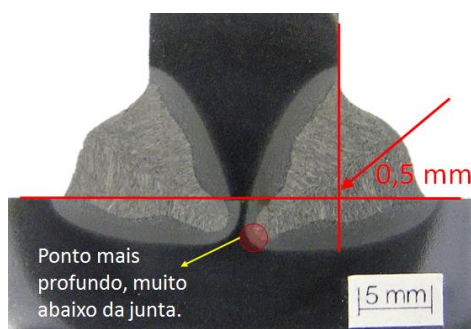
Figura 7. Ponto mais profundo da fusão ocorrendo muito abaixo da raiz do filete.
