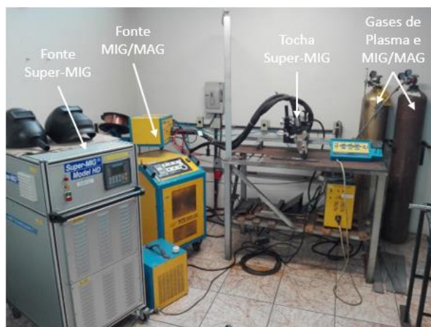
Figura 2. Bancada de ensaios para soldagem de juntas em filete de 8, 10 e 12 mm de espessura.
