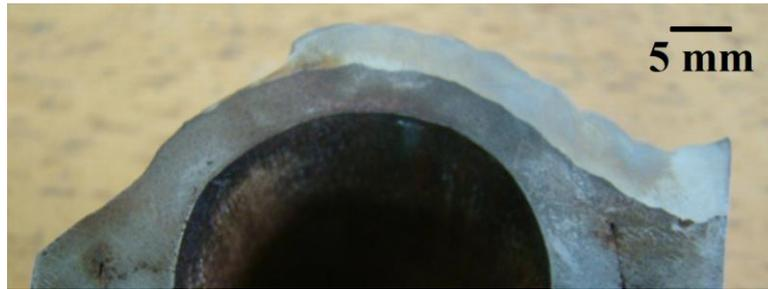
**Figura 10- Metalografia referente ao processo MIG/MAG pulsado.**
