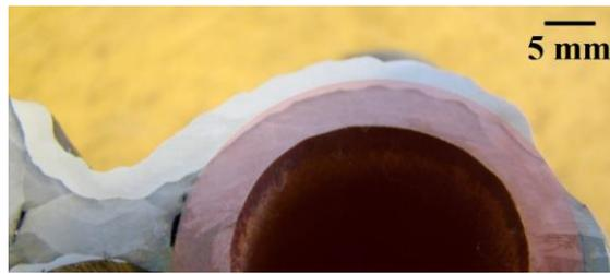
**Figura 6: Imagem da metalografia referente à soldagem de revestimento superficial com o programa MIG/MAG convencional com destacamento de gota por curto circuito.**
