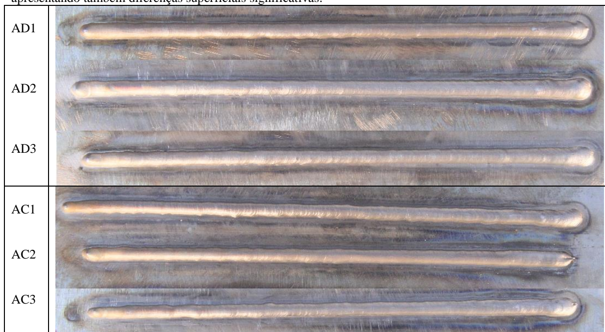
Figura 8. Cordões de solda realizados AD – Alimentação Dinâmica e AC – Alimentação Contínua.
