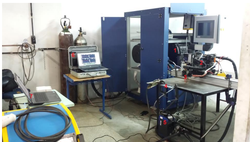
Figura 4. Bancada de ensaios com: 1 – Fonte de Soldagem e Cabeçote Alimentador, 2 – Manipulador Robótico, 3 – Tocha e alimentador de arame, 4 – Chapa plana, 5 – Câmera Termográfica FLIR SC 7000, 6 – SAP e 7 – Computador para aquisição de imagens termográficas.
