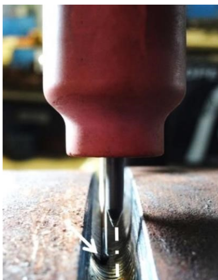
Figura 2. Desvio do arame descentralizado em relação ao eletrodo.
