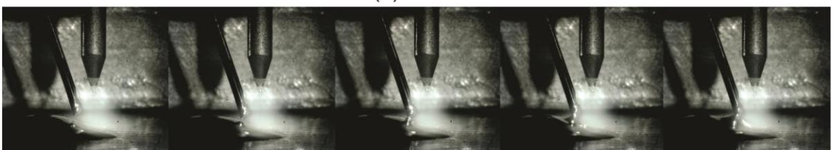
Figura 2 – Ilustração da transferência metálica. (a) transferência em ponte (b) transferência destacada
