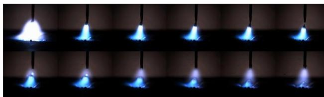
Figura 5. Sequencia de quadros de filmagem em alta velocidade (4000 quadros/s), da transferência metálica para o processo MIG/MAG Pulsado.
