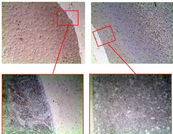
Figura 23. Micrografias da região interfacial metal de solda - substrato, das regiões com, à dir., e sem, à esq., pós-tratamento superficial por processo TIG.
