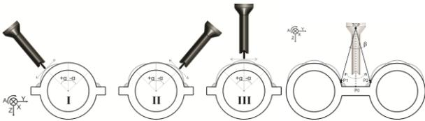
Figura 31. Movimentos de oscilação da tocha (tecimento) para cada tipo de cordão de solda (sobre tubos ou sobre membranas) para produção do revestimento.
