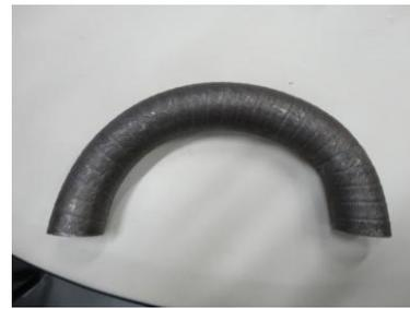
Figura 20. Tubo revestido submetido e aprovado em ensaio de dobramento.
