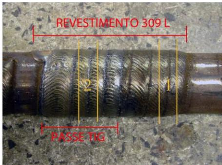
Figura 18. Segmento de tubo revestido e configuração dos cortes para extração de corpos de prova das regiões com e sem pós-tratamento superficial por processo TIG.
