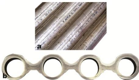
Figura 32. Revestimento produzido com a técnica alternativa de sequenciamento dos cordões e procedimento desenvolvido no LABSOLDA para soldagem na posição vertical.
