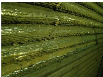
Figura 1. Exemplo de revestimento aplicado manualmente.
