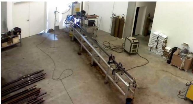
Figura 26. Sistema de revestimento de tubos individuais desenvolvido e construído, em operação.
