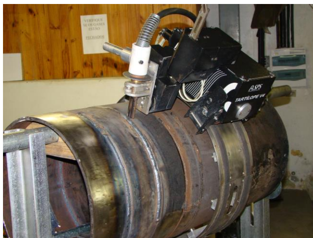
Figura 6. Manipulador robótico utilizado nos testes de soldagem orbital.
