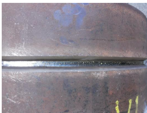
Figura 14. Aspecto do passe de raiz soldado no tubo com o processo CCC.
