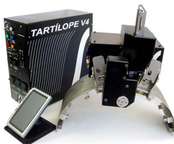
Figura 2 - Tartilope V4, manipulador robótico com quatro graus de liberdade, três prismáticos e um rotacional [9]
